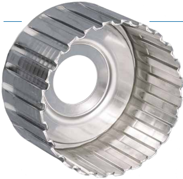
Kaltgewalzter Lamellenträger mit Innen- und Aussenverzahnung
